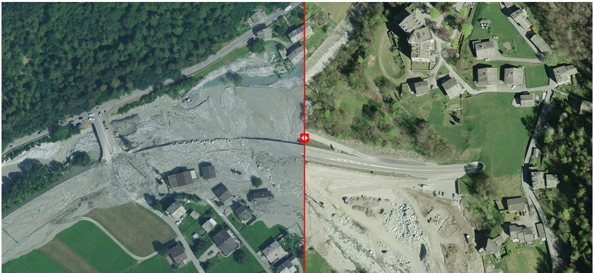
Illustration 7 : ex. de produit « quick orthophoto » : comparaison avec SWISSIMAGE, capture d'écran map.geo.admin.ch (pré-catastrophe, année de vol 2015, à droite). Bondo, 25 août 2017, à gauche, source : OFEV / swisstopo
